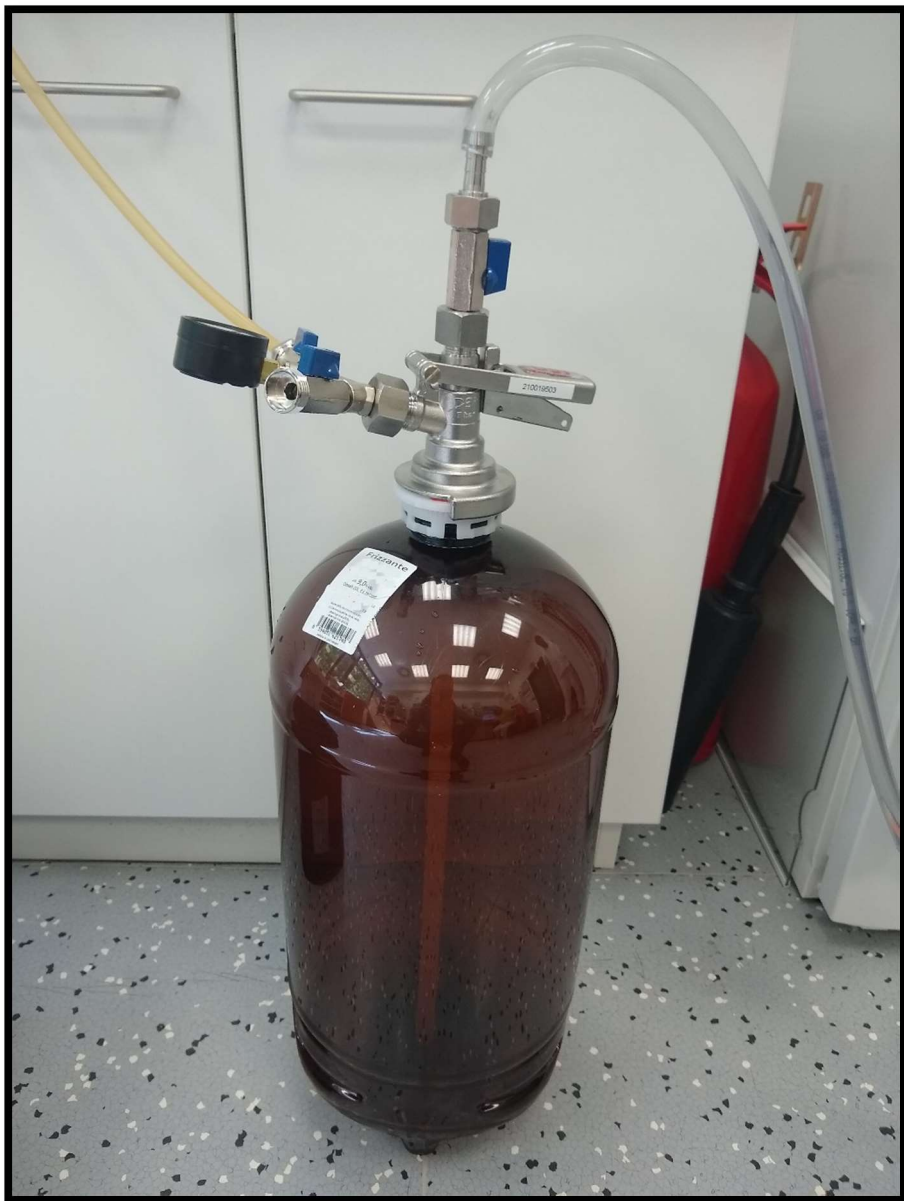
Obr. 15 a 16 Opětovné plnění obalu PETAINER KEG (vodou)
